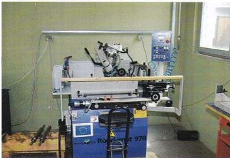
Elektronicznie sterowana ostrzałka do noży profilowych, służących do obróbki drewna.
