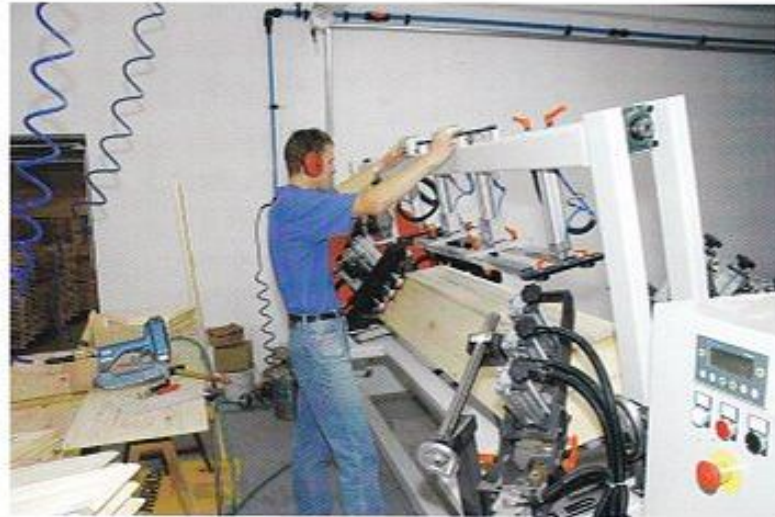
Zautomatyzowany montaż trumien.
